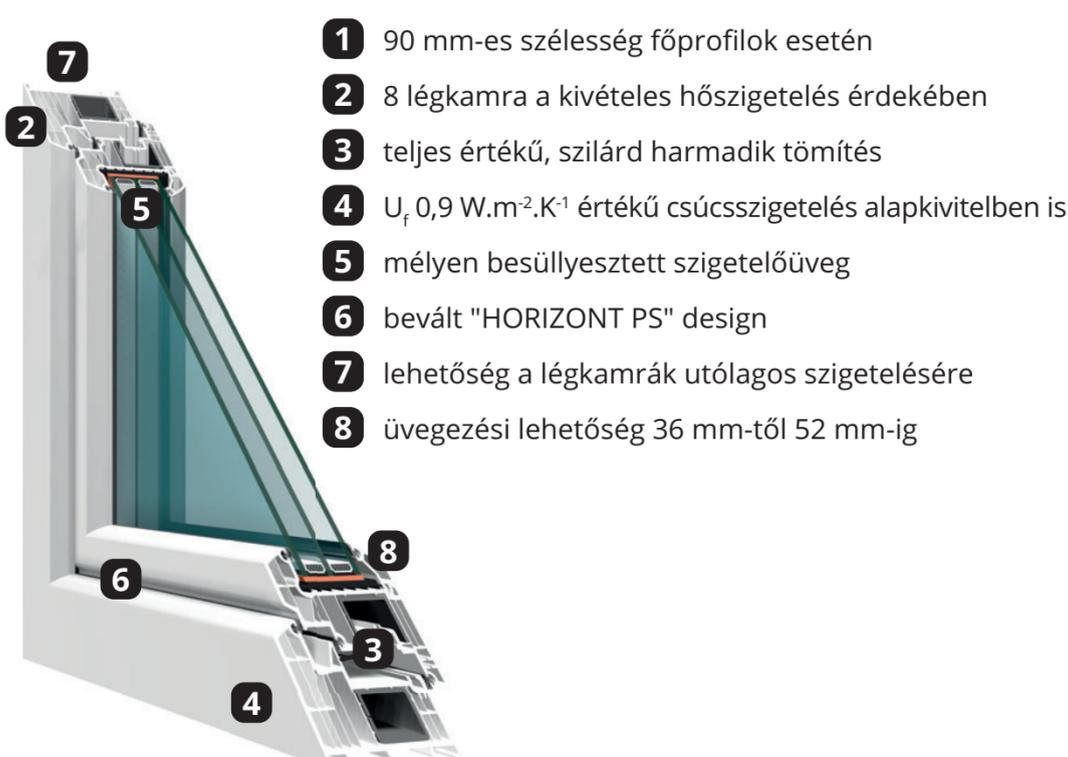
HORIZONT PS® SPACE 8 – műanyag profilrendszer ablakgyártáshoz
